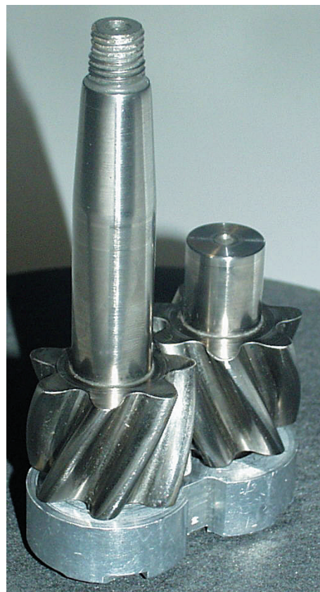
Fig. 10 - Aspetto dei rotori-ingranaggi di una pompa a contatto continuo. Queste pompe sono attualmente realizzate e industrializzate con il marchio Continuum, dalla Settima Flow Mechanism.
